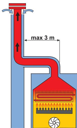
Collegamento aria/fumi mediante condotti coassiali nel locale caldaia, e monoparete nella canna fumaria (aria comburente controcorrente nella canna fumaria)
