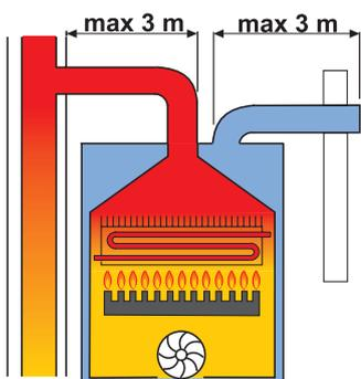
Collegamento ad un terminale per il prelievo dell'aria comburente e scarico fumi mediante camino individuale o collettivo.
