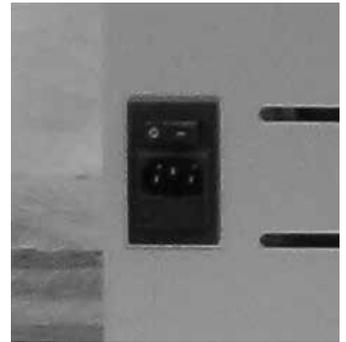
**Sécurité électrique:** l'hydropoêle est protégé contre les brusques coupures d'électricité (ex. foudre) par un fusible général à 4 A placé sur le panneau de contrôle situé à l'arrière de l'hydropoêle près du cordon d'alimentation. Les fusibles de protection des cartes électroniques sont disponibles sur les planches.
