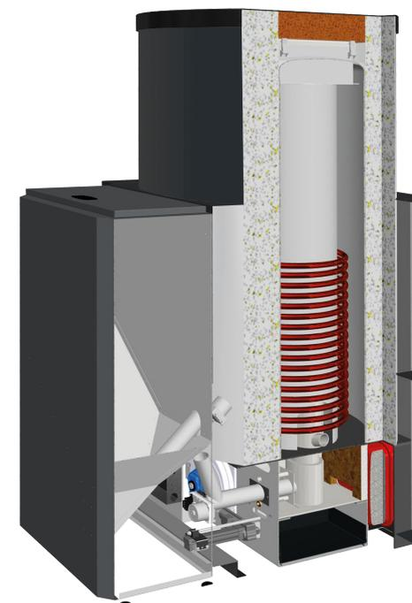
Caldaia a pellet con integrato puffer di acqua tecnica da 650 litri, dotata di esclusivo sistema di dosaggio del combustibile che consente un'ampia modulazione della potenza erogata. Innovativo è il sistema automatico di pulizia del braciere che semplifica, in modo efficace le operazioni di manutenzione e pulizia. Produzione di A.C.S. integrata tramite serpentino incorporato provvisto di ciclo antilegionella.
