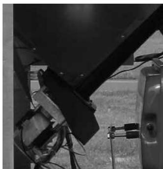
**Motoréducteur:** si le motoréducteur s'arrête, la chaudière continue à fonctionner jusqu'à ce que la flamme ne disparaisse par manque de carburant et jusqu'à ce qu'il atteigne le niveau minimum de refroidissement.
