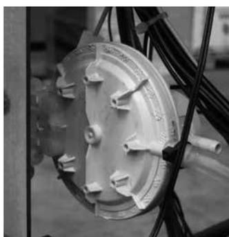
**Interrupteur de pression de fumée:** contrôle la pression dans le conduit de fumée. Il bloque la vis de chargement des pellets en cas de blocage du conduit de fumée ou de contre-pressions importantes, par exemple en présence de vent, d'une porte ouverte de la chambre de combustion ou d'une défaillance d'extracteur de fumée. Lorsque le pressostat est activé, l'écrite "ALARODEP0FAIL" apparaîtra.
