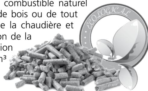
**Pour nos produits, utiliser du granulé de bois avec un diamètre de 6 mm, longueur de 30 mm et un maximum de 8% d'humidité et certifiés EN Plus A1 de préférence SK002 conformément à la norme UNI EN ISO 17225-2. Conserver les granulés de bois loin des sources de chaleur et non pas dans des environnements humides ou avec des atmosphères explosives.**
