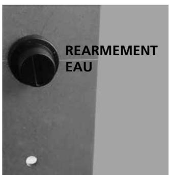
**Thermostat de sécurité à réarmement manuel pour la température de l'eau:** si la température de l'eau dépasse le niveau de sécurité programmée à 100° C arrête immédiatement le fonctionnement de l'appareil et l'écran affiche "ALAROSIC0FAIL". Pour la redémarrer, vous devez dévisser le couvercle noir et appuyez sur le bouton blanc. Si vous entendez "clic" cela signifie que le thermostat a été réarmé; sinon, attendez que la température de l'eau baisse et répéter l'opération..
