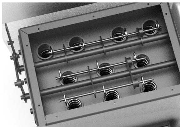
È possibile effettuare la pulizia dopo aver tolto le molle inserite in ogni tubazione. L'operazione è semplice sfilando le molle dal perno orizzontale a cui sono fissate. Per eseguire l'operazione, il perno orizzontale può essere sfilato attraverso un foro posto sulla parete del corpo caldaia.
