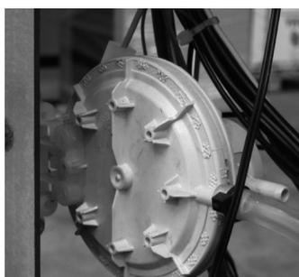
**Pressostato fumi:** controlla la pressione nel condotto fumario. Esso provvede a bloccare la coclea di caricamento pellet nel caso lo scarico sia ostruito o ci siano contropressioni significative ad esempio in caso di presenza di vento, di porta della camera di combustione aperta o guasto dell'estrattore fumi. Nel momento di intervento del pressostato apparirà la scritta **"ALAR-DEP-FAIL"**.
