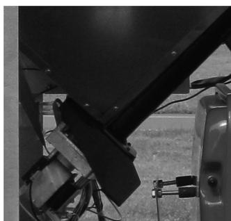
**Motoriduttore:** se il motoriduttore si ferma per la segnalazione **"ALAR-DEP-FAIL"** o **"ALAR-SIC-FAIL"** la caldaia continua a funzionare fino a quando non si spegne la fiamma per mancanza di combustibile e fino a che non raggiunge il livello minimo di raffreddamento.
