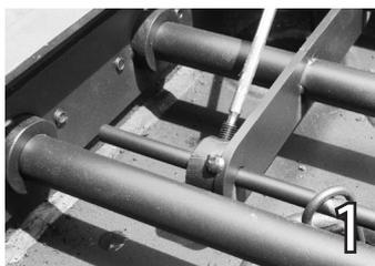
L'operazione deve essere completata svitando con un cacciavite le bussole di fissaggio (foto 1). Rimuovere le viti che fissano il kit pulizia al corpo macchina ed estrarlo completamente (foto 2 - 3).
