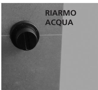
**Termostato di sicurezza a riarmo manuale per la temperatura dell'acqua:** se la temperatura dell'acqua supera il valore di sicurezza impostato a 100 °C si arresta immediatamente il funzionamento della caldaia e sul display apparirà la scritta **"ALAR-SIC-FAIL"**. Per riavviarla è necessario ripristinare il termostato manualmente.
