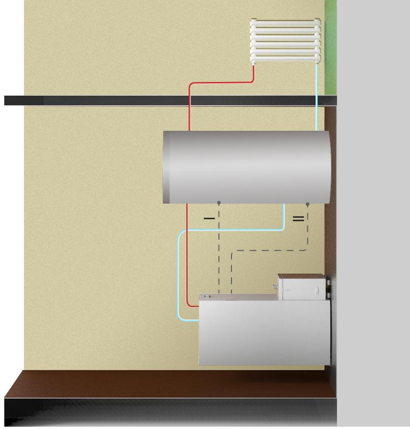
Lo schema è indicativo e vuole dimostrare solo il funzionamento ed i componenti che possono essere gestiti dalla caldaia/termostufa. Eventuali pompe di rilancio devono essere comandate separatamente dalla caldaia/termostufa.
