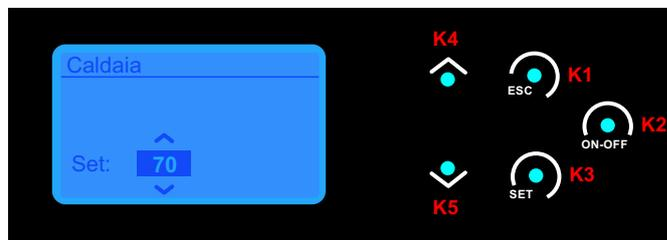
Per impostare la temperatura dell'acqua in caldaia agire sui tasti **K4** e **K5** per confermare premere il Tasto **K3** (la temperatura min impostabile è 60°C e la max 80°C). Per ritornare al menu precedente agire sul tasto **K1**.
