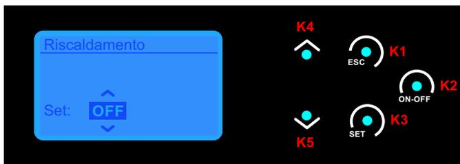
Per selezionare la potenza di ventilazione utilizzare i tasti **K4** e **K5**, per confermare premere il tasto **K3** (le potenze selezionabili sono **P1-P2-P3-P4-P5-P6** e **AUTO**, si consiglia di utilizzare **AUTO** in maniera che l'apparecchiatura regoli la potenza automaticamente in funzione della richiesta dell'impianto).
