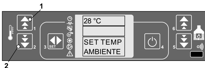
panneau de commande - modification de la température ambiante
