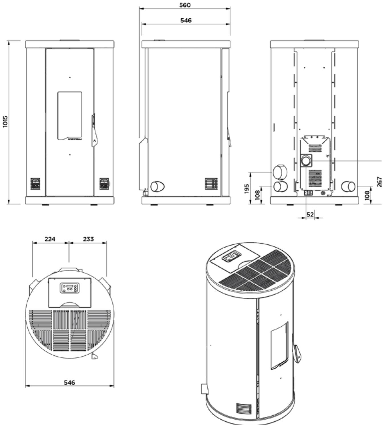
Dimensioni (mm) - Dimensions (mm) - Abmessungen (mm)
