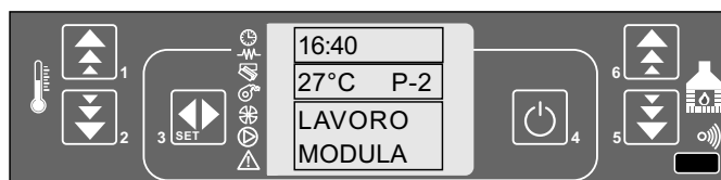
pannello comandi - modulazione temperatura impostata
