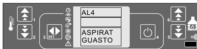
pannello comandi - allarme mancata accensione
