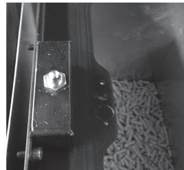
**\* Microinterruttore sportello pellet:** all'apertura dello sportello carico pellet la stufa interrompe l'alimentazione del pellet e se rimane aperto per più di 120" la stufa si spegne per l'errore **"ALAR-DEP-FAIL"**.
